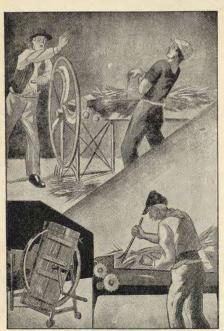
Quando il trinciaforaggi è in riposo, applica la custodia. Quando è in funzione, usa per imboccare una forcella di legno.
